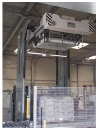
Arbeitsweise: (1) Haube vorbereiten; (2) Haube dehnen; (3) Rahmen abwärts; (4) Haube abrollen
