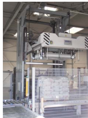
Arbeitsweise: (1) Haube vorbereiten; (2) Haube dehnen; (3) Rahmen abwärts; (4) Haube abrollen
