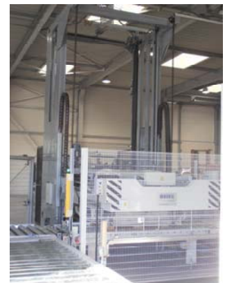
Arbeitsweise: (1) Haube vorbereiten; (2) Haube dehnen; (3) Rahmen abwärts; (4) Haube abrollen
