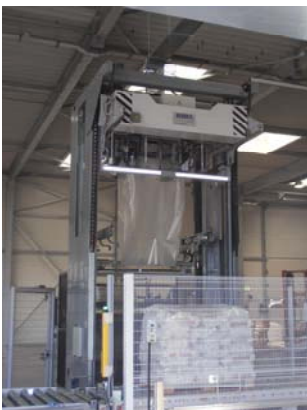
Arbeitsweise: (1) Haube vorbereiten; (2) Haube dehnen; (3) Rahmen abwärts; (4) Haube abrollen
