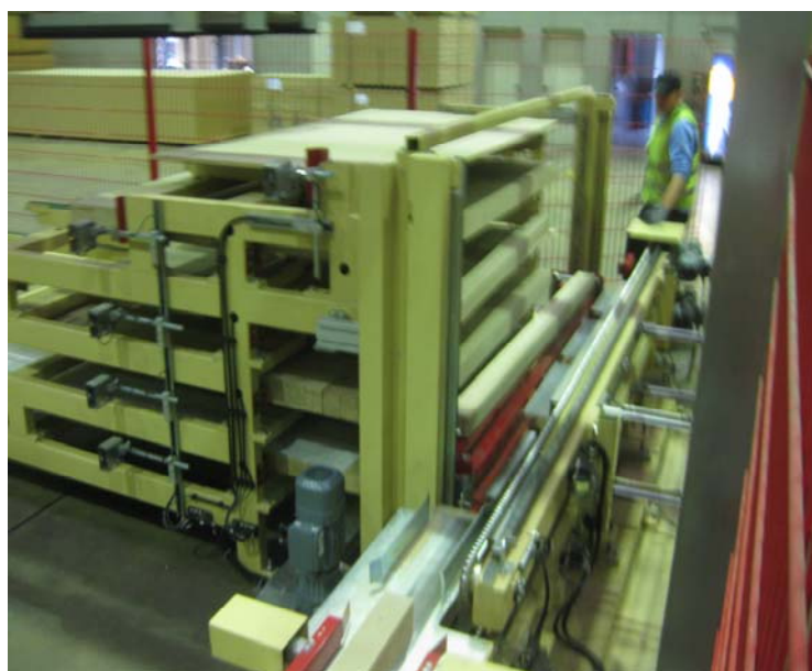
Zwischenförderer zur Vereinzelung der verschiedenen Kanhölzer bzw. Leisten
