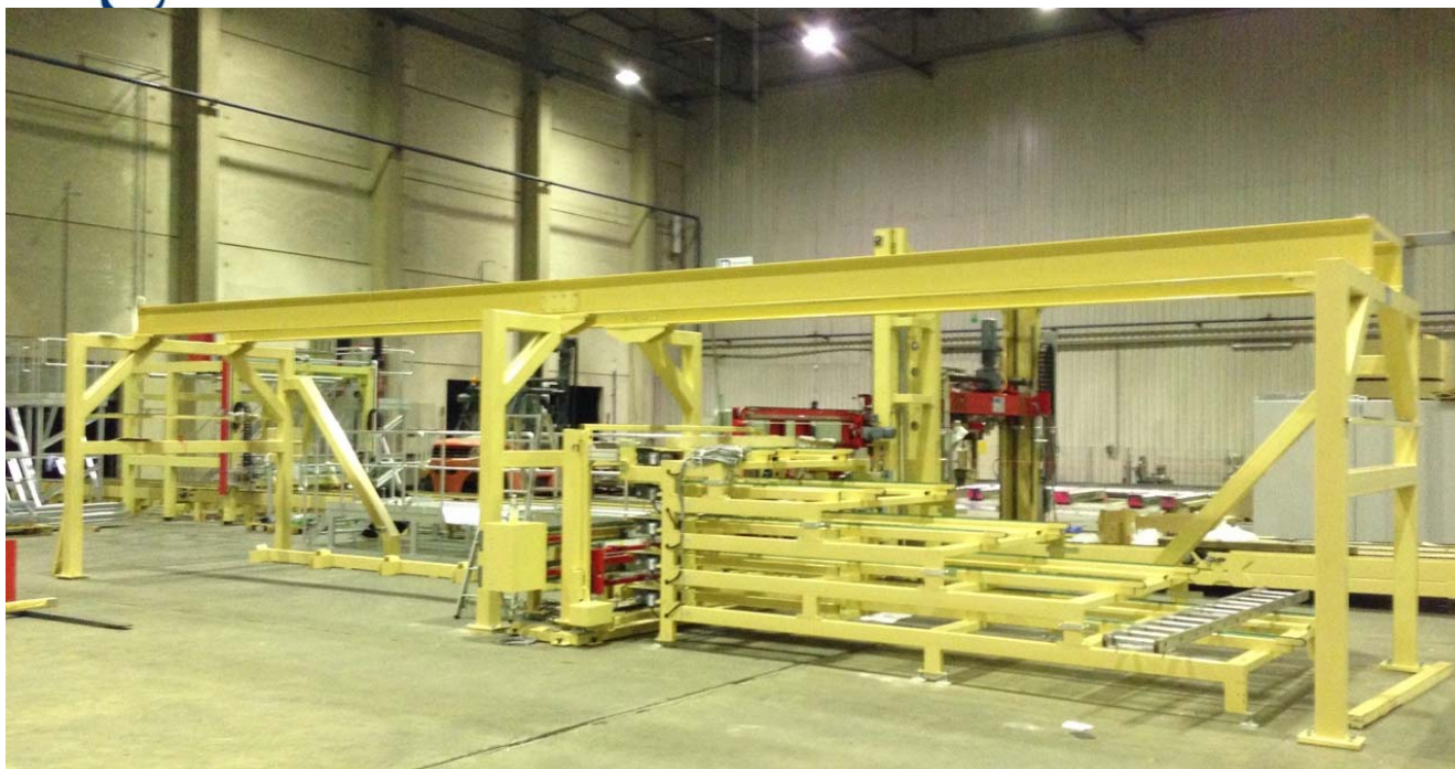
Im Vordergrund die Saugtraverse, dahinter die eigentliche Umreifungsmaschine.
