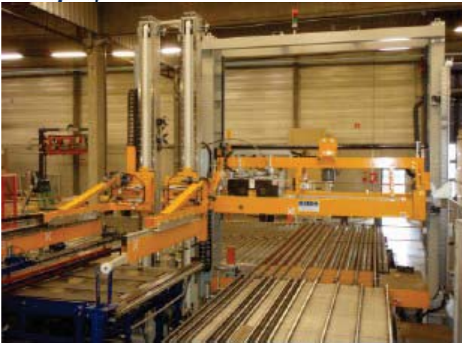
Maschinenansicht: ganz links der Roboterarm für die Kanthölzer, daneben der Arm für die Leisten.
