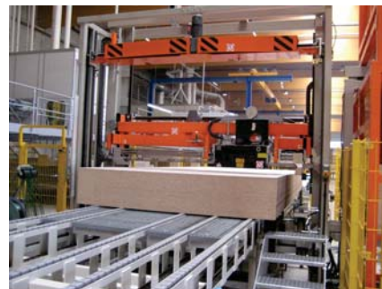
Umreifungsmaschine bei der Arbeit
