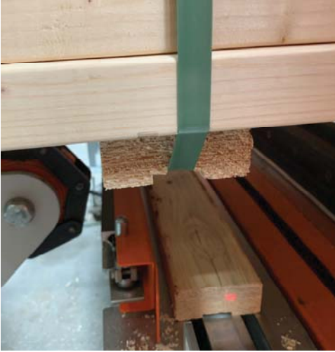
Kantholzeinschub mit bereits gefräster Nut. Das nächste Kantholz ist bereits vorbereitet
