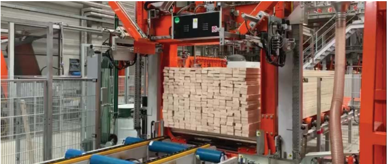
Kantholzeinschub mit bereits gefräster Nut. Das nächste Kantholz ist bereits vorbereitet
