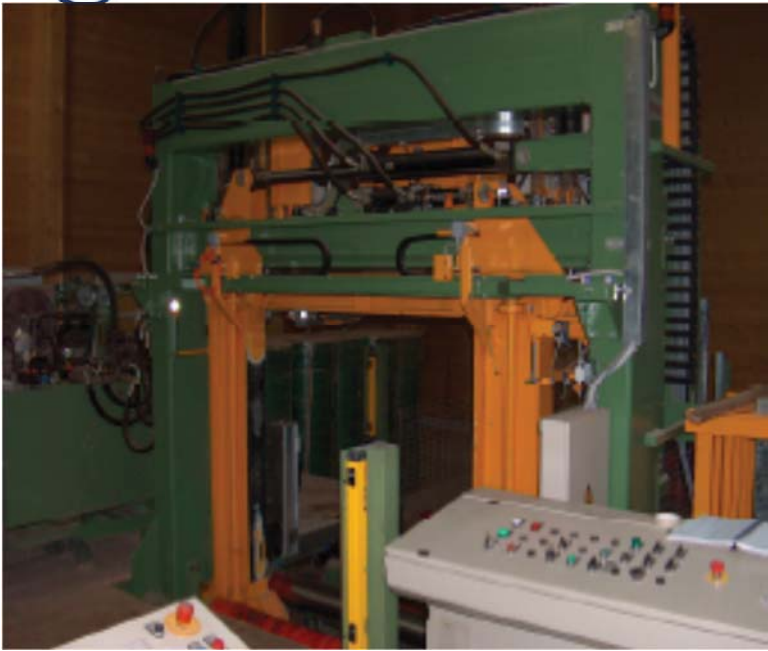
Maschine 2004: ausgestattet mit 4-fach Presse und Winkelanleger
