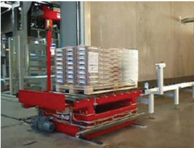
Verfahrwagen bringt das Produkt zur Abnahmestrecke
