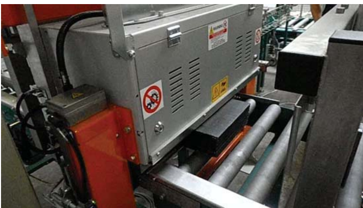
Arbeitsweise: Paket fährt ein (oben) Kopf senkt sich und umreift (unten)
