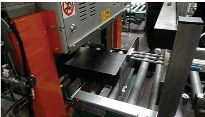
Arbeitsweise: Paket fährt ein (oben) Kopf senkt sich und umreift (unten)
