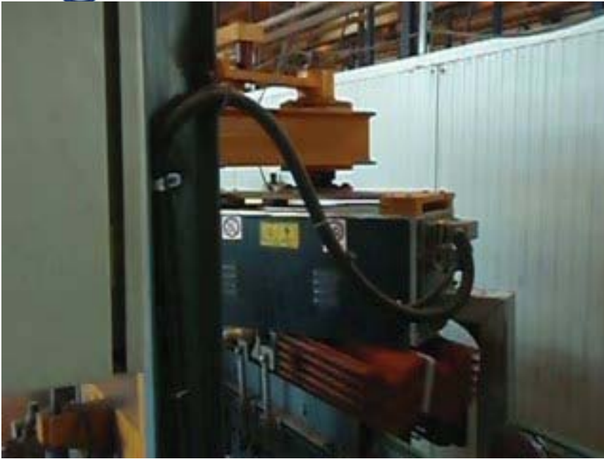
Umreifungskopf in Umreifungsposition.
