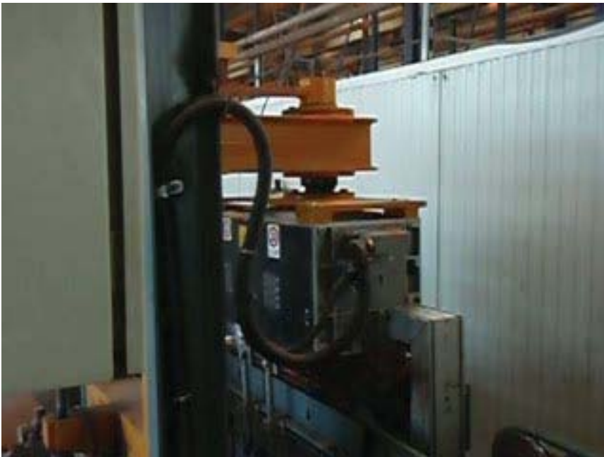
Umreifungskopf in Warteposition. Das Paket kann transportiert werden.
