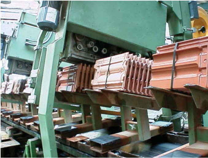
Vertikale Kleinpaketumreifung—2 Maschinen hintereinander für hohe Leistung
