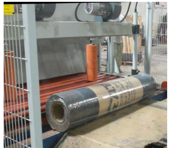
Verpackte Rolle am Ausgang des Schrumpftunnels
