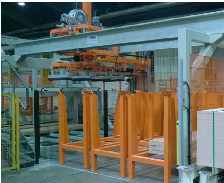
3 Leistenboxen mit der Saugtraverse, die die einzelnen Kantholzlagen auf Vereinzelungsförderplätze positioniert
