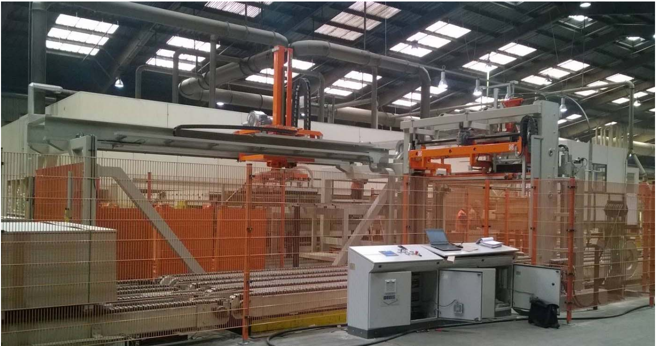
Im Vordergrund die Transportstrecke mit der eigentlichen Umreifungsmaschine. im Hintergrund die Saugtraverse
