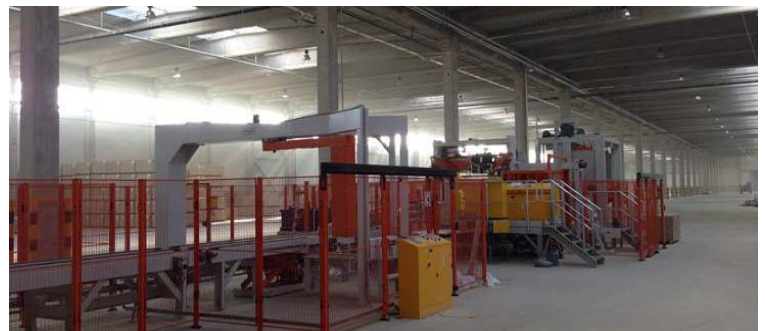
die beiden Dreharmwickler stehen am Ende der jeweiligen Transportlinie, unmittelbar nach den Umreifungsmaschinen
