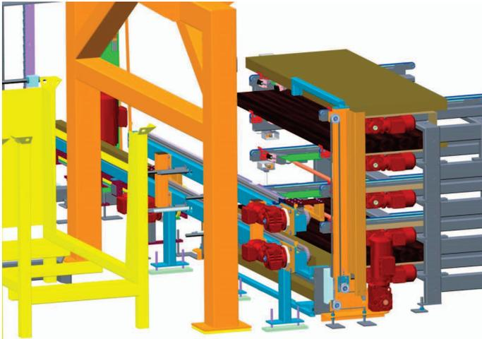
Lagenförderer: einzelne Kantholz-Leistenlagen werden auf einem Fördersystem zwischengelagert und für die Zubringung zur Umreifungsmaschine vereinzelt.
