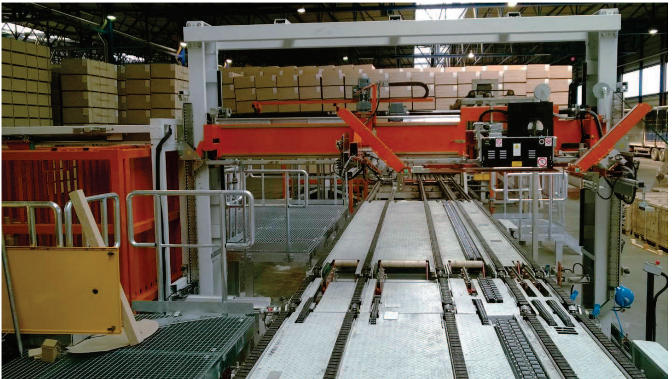
Maschine mit Kantholzeinschub, Winkelanleger und Magazin
