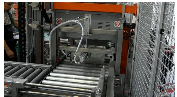
Arbeitsweise: Kopf hebt sich (oben) Paket fährt aus (unten) Dauer pro Zyklus: 4 Sekunden
