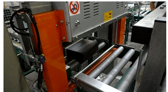
Arbeitsweise: Kopf hebt sich (oben) Paket fährt aus (unten) Dauer pro Zyklus: 4 Sekunden
