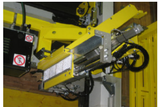
Winkelanlegevorrichtung oben—das Magazin kann ca. 150 Winkel aufnehmen
