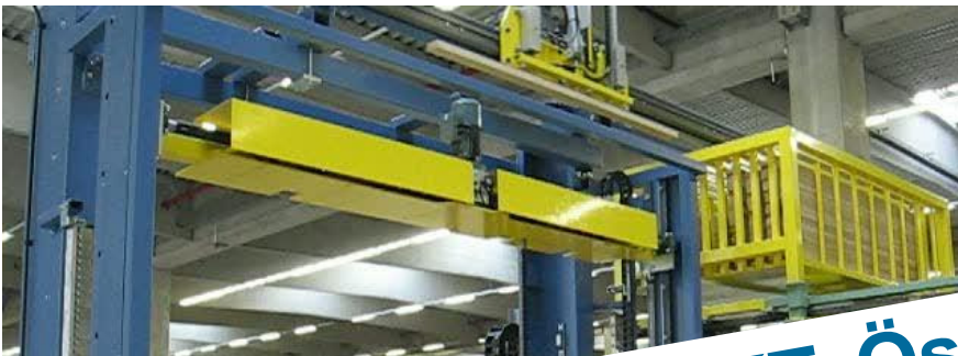
Übergabe der Leisten vom vertikalen Leistentransport in die Umreifungsposition
