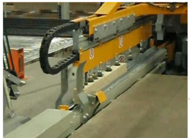
Roboterarm saugt ein Kantholz an
