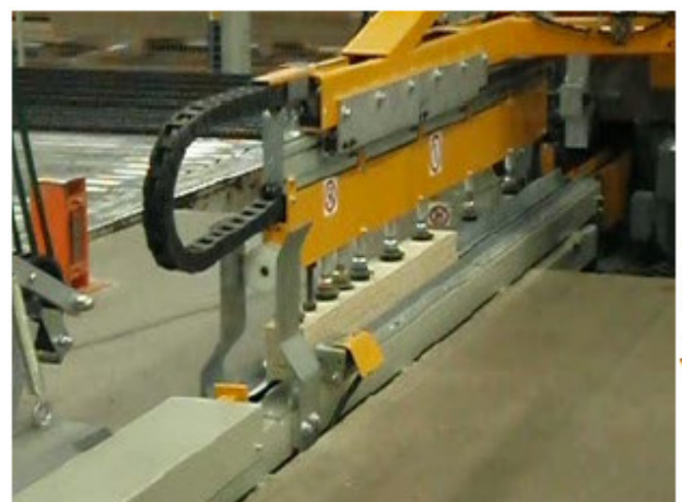
Roboterarm saugt ein Kantholz an
