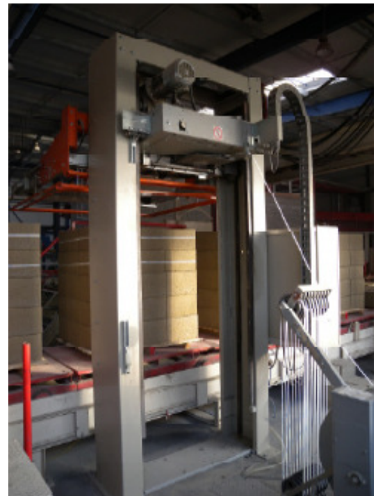
Maschine mit Abroller (weißes bedrucktes PET)
