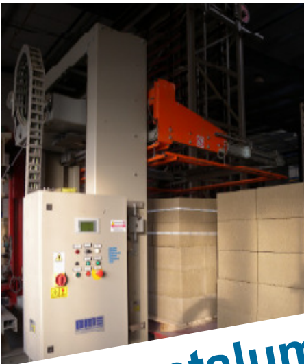
Umreifungsmaschine in Ausgangsposition
