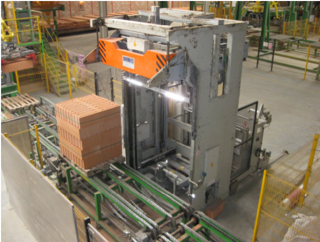
Paket fährt ein, Sack wird vorbereitet
