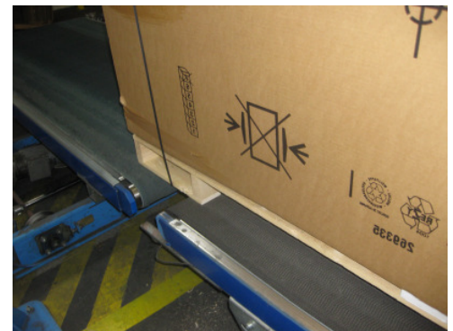
Umreifung wahlweise durch den Palettenboden oder unter der Palette, wie abgebildet
