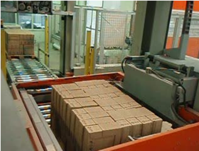
Maschine bereit für die 1. Umreifung..
