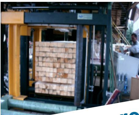
Maschine 2001: Doppelkopf für Stahlband und Kunststoffband und 4-fach Presse
