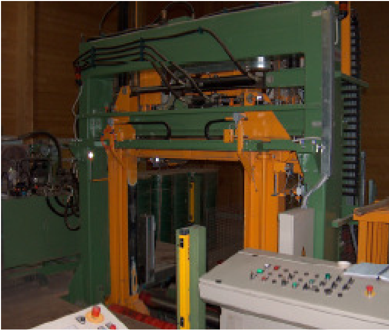
Maschine 2004: ausgestattet mit 4-fach Presse und Winkelanelger
