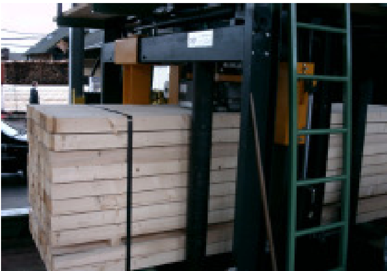
Maschine 2001: Doppelkopf für Stahlband und Kunststoffband und 4-fach Presse
