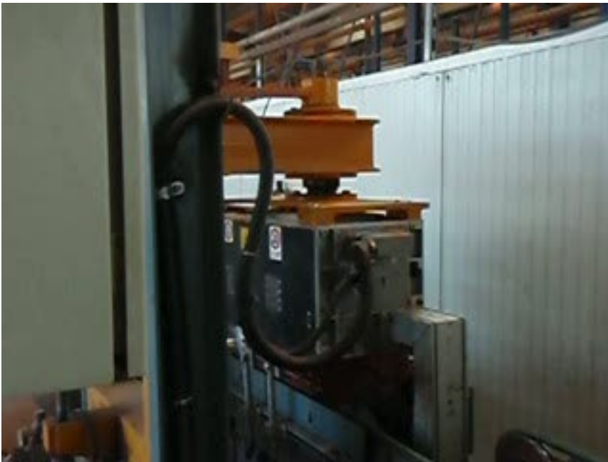
Umreifungskopf in Warteposition. Das Paket kann transportiert werden.
