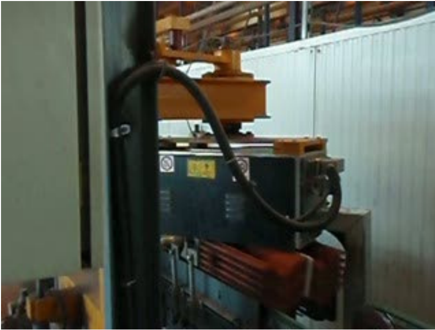
Umreifungskopf in Umreifungsposition.
